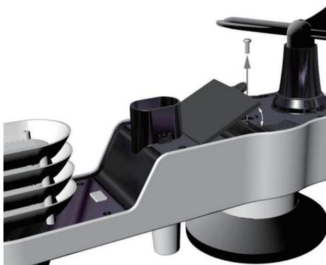
Legen Sie 3 frische Batterien vom Typ AA (Mignon) in das Batteriefach ein, wie der nächsten Abbildung gezeigt. Wir empfehlen die Verwendung von Li-Ionen-Batterien (nicht LiIon-Akkus!), die in der Regel länger als 1 Jahr halten und oftmals über einen deutlich erweiterten Arbeitstemperaturbereich verfügen.
