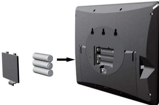
Setzen Sie den Batteriefachdeckel wieder ein, klappen Sie den Tischständer aus und stellen Sie die Anzeigeeinheit in eine aufrechte Position.
