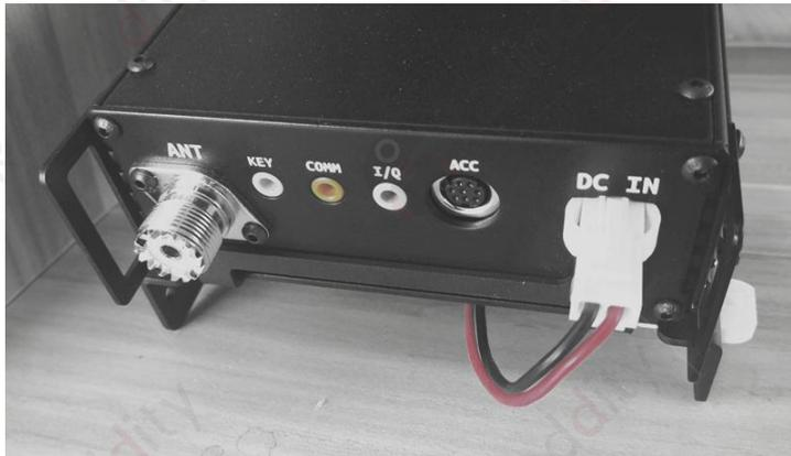
3. Befestigen Sie das Netzkabel des G90 an die entsprechende Schnittstelle auf der Kühlhalterung.
