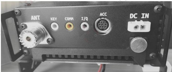
2. Schließen Sie den Netzstecker der Kühlhalterung an die dafür vorgesehene DC IN-Buchse des G90.
